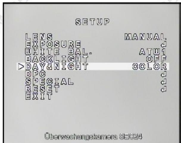
**DPC:** DEAD PIXEL CANCEL (beseitigt tote Pixel im Bild, die durch Produktionsfehler des Bildsensors auftreten können)
