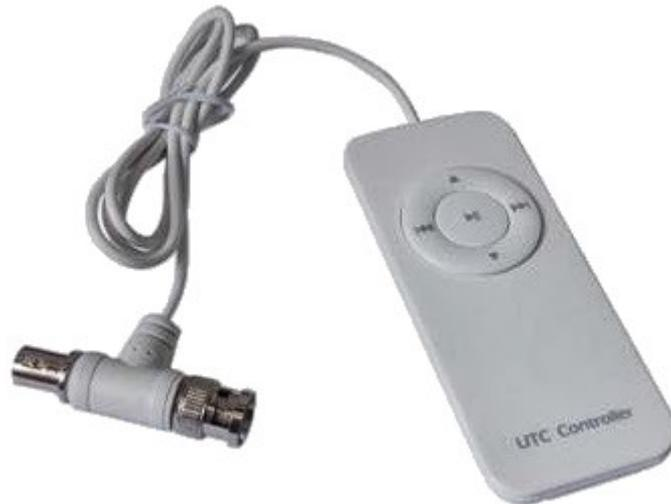
der UTC-controller verfügt über einen T-Anschlußstecker mit BNC-Buchse und BNC-Stecker. Er wird einfach beliebig in der Videoleitung der Kamera dazwischen geklemmt. Die Taste in der Mitte funktioniert wie eine Enter-Taste, die Pfeiltasten dienen zur Navigation innerhalb des Systemmenüs.
