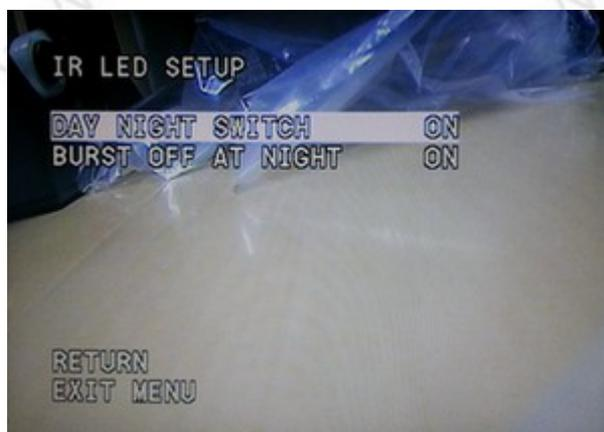
**DAY NIGHT SWITCH:** Tag-Nacht-Umschaltung. Hier kann gewählt werden, ob sich das Infrarotlicht bei Nacht automatisch durch den Dämmerungssensor einschalten soll.
