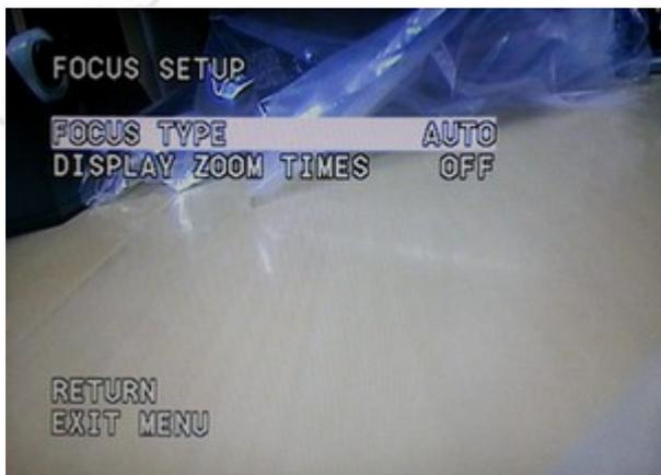
**FOCUS TYPE:** Auswahl ob das fokussieren nach einem Kamerazoom automatisch oder manuell erfolgen soll.
