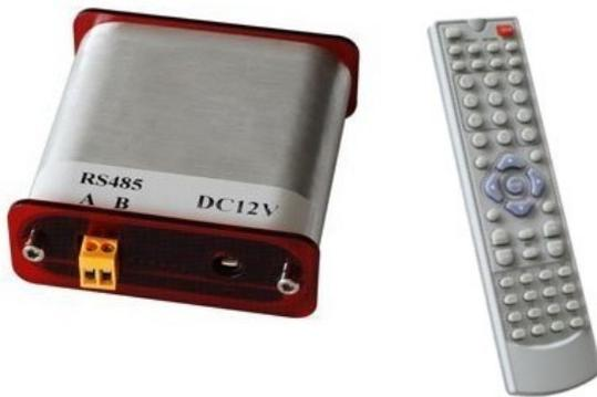
Verbinden Sie die mit RS485 gekennzeichneten Anschlüsse der Kamera mit den RS485 n Anschlüssen des Funkcontrollers. Der rote Anschluß (Kabel=lila) der Kamera entspricht dem Anschluß A des Funk-Controller Empfängers, der schwarze Anschluß (Kabel=grau) dem Anschluß B. Der Anschluß kann auch über ein Verlängerungskabel erfolgen, z.B. wenn der Funk-Controller nicht in unmittelbarer Nähe der Kamera platziert wird. Achten Sie aber unbedingt darauf, daß die Polung nicht vertauscht wird.
