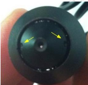
**Hinweis:** sollte das Bild Ihrer Kamera nicht scharf dargestellt werden, können Sie das Objektiv durch leichtes Drehen nachjustieren. Nehmen Sie hierfür am besten einen Zahnstocher aus Holz und fahren in eine der beiden gegenüberliegenden Öffnungen und drehen das Objektiv vorsichtig zuerst nach links und ggf. nach rechts bis das Bild vollkommen scharf ist. Der Hersteller verwendet normalerweise ein Gleitmittel, damit sich das Objektiv leicht drehen lässt.
