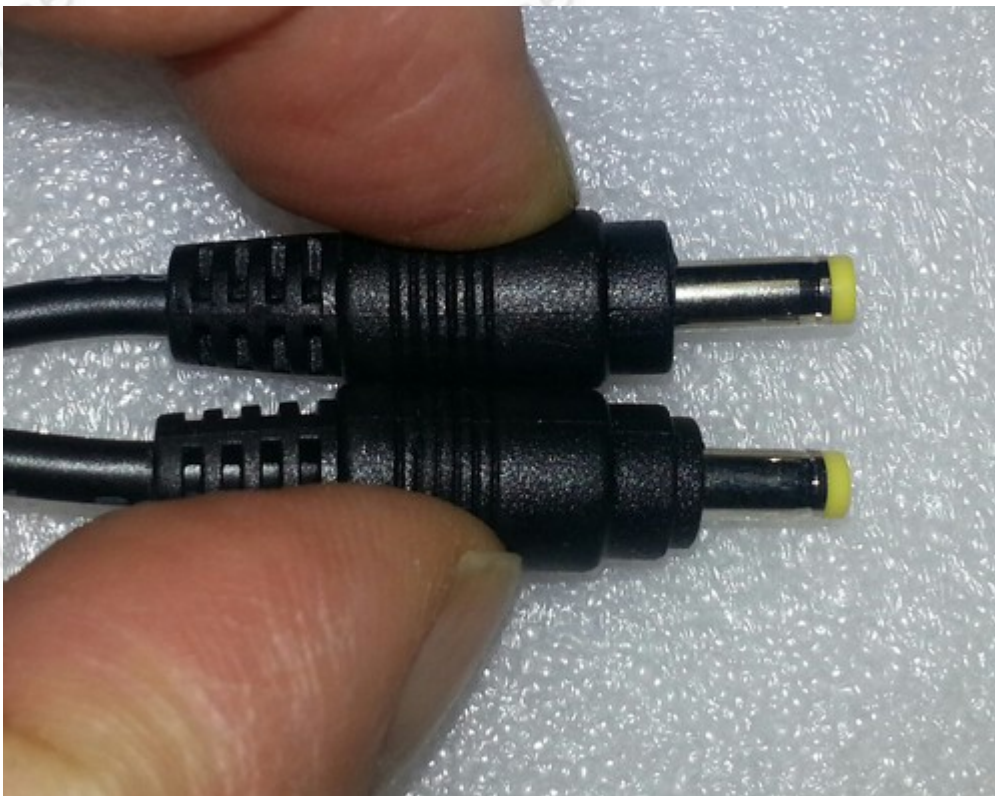
oben: gekürzte Isolierung, unten: normale Isolierung.
