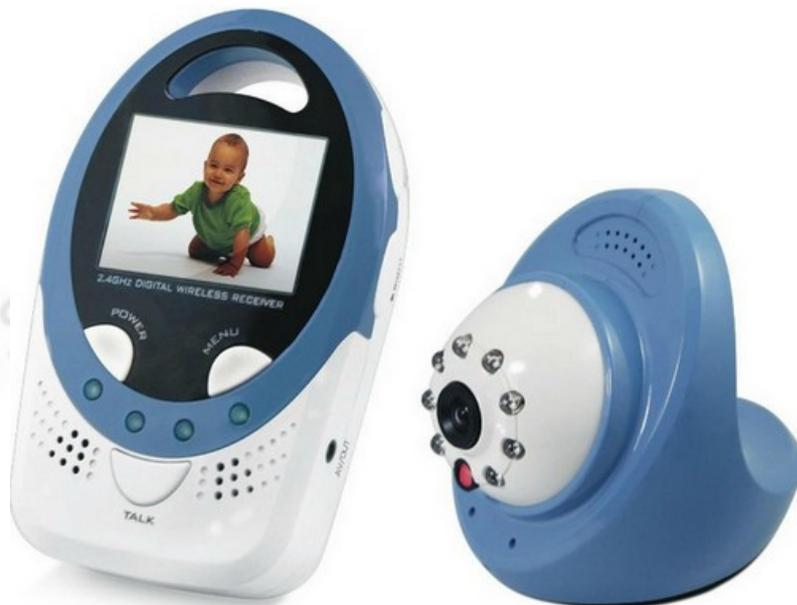
**Nach dem Einschalten** beider Geräte erkennt der Receiver augenblicklich die Kamera und zeigt diese auf dem TFT-Monitor an. In der linken oberen Ecke befindet sich eine Skala, welche die Empfangsstärke der Kamera anzeigt. In unserem Test wurde die Kamera im Dachgeschoß positioniert. Mit dem Receiver war die Kamera im ganzen Haus, einschl. im Keller ohne Probleme und ohne Störungen zu empfangen.
