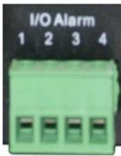
Jede Apexis IP-Kamera verfügt über einen Alarm-Eingang sowie einen Alarm-Ausgang. PIN 3 + 4 werden als Alarm-Eingang bezeichnet. An diese Pin kann z.B. ein externer Bewegungsmelder, Lichtschranke usw. angeschlossen werden. Die Steuerung erfolgt wie auf Seite 21 / 22 beschrieben über das Systemmenü der Kamera. Der Bewegungsmelder agiert hierbei wie ein einfacher externer Schalter, der im Prinzip nur Pin 3+4 überbrückt und dadurch einen Alarm auslöst.
