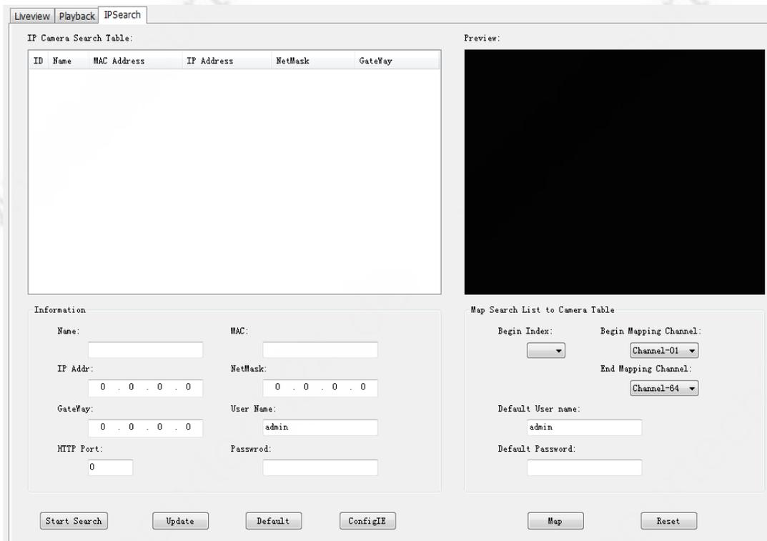
Um die Kamera im Netzwerk zu finden, klicken Sie unten links auf **Start Search**. Schließen Sie die Kamera aber zuvor per Netzwerkkabel an den Router, auch wenn Sie die Kamera später kabellos per WLAN nutzen möchten.
