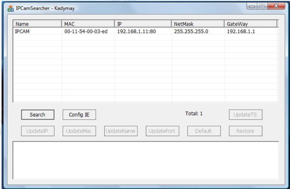
Wird die IP-Kamera gefunden, erscheint die von Werk eingestellte Konfiguration in dem Tabellenfenster des Tools. Die hier im Beispiel angezeigten Angaben können von den tatsächlich angezeigten IP-Adressen abweichen, je nachdem wie die IP-Kamera von Werk aus programmiert wurde.
