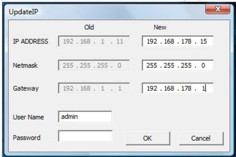
Unter **Old** werden die von Werk eingestellten IP-Adressen angezeigt. Unter **New** werden die gewünschten neuen Daten, passend zu dem Adressbereich des eigenen Netzwerks
