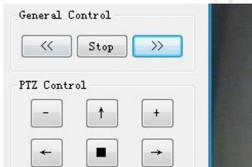
Das Feld PTZ Control (PTZ = Pan, Tilt, Zoom = Schwenken, Neigen, Zoomen) ist nur für die Steuerung der Kamera zuständig. Die Funktionen sind analog zu den Funktionen der Weboberfläche.
