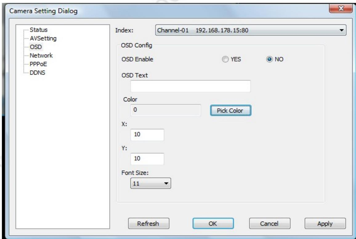
Hier kann ein freier Text definiert werden, der im Kamerabild eingeblendet wird. Die gewünschte Kamera für die diese Einstellungen gelten sollen wird oben unter Index ausgewählt.
