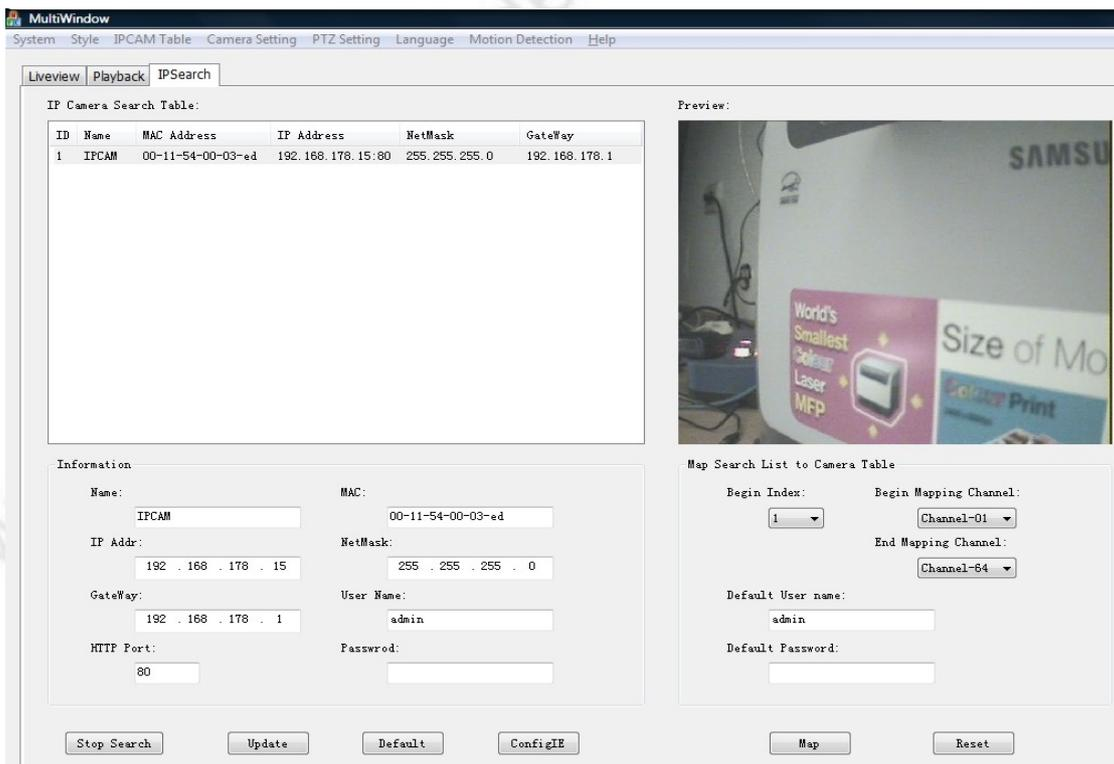
Die Kamera, oder die Kameras, sollten innerhalb von kurzer Zeit gefunden werden und im Feld **IP Camera Search Table** gelistet werden. Um eine Kamera einzubinden klicken Sie diese einfach an, die vorhandenen Parameter werden jetzt unten im Feld **Information** übernommen.
