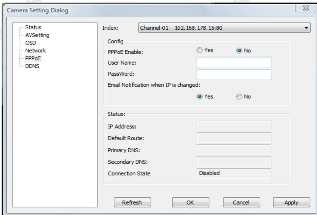
Diese Einstellungen sind nur relevant, falls die Kamera nicht an einen Router, sondern direkt an ein DSL-Modem angeschlossen wird.
