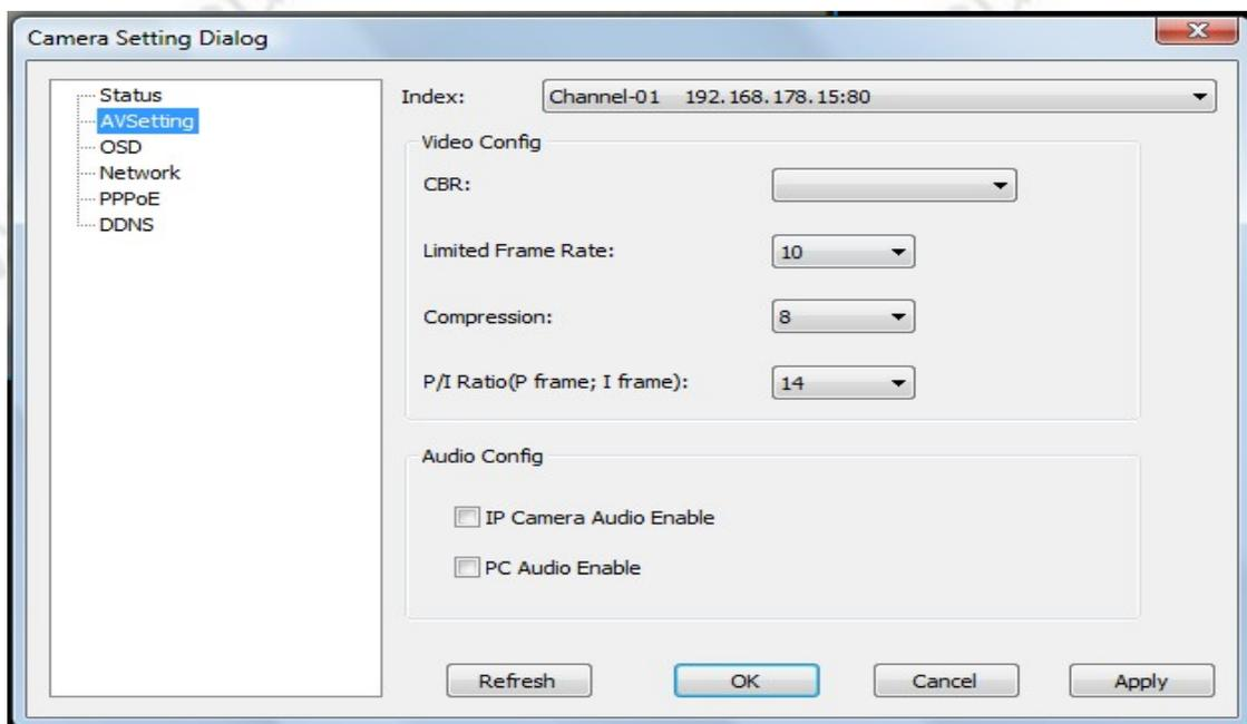
Unter **AVSetting** werden Einstellungen gemacht, die für die Videoqualität relevant sind. **CBR** bedeutete Constant Bit Rate und bezeichnet den Datenstrom von der Kamera kommend. Je höher der Datenstrom, umso höher die Bildqualität. Aber umso höher auch
