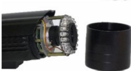
Falls ein anderer Sichtwinkel erwünscht ist, kann das vorhandene Objektiv durch ein Objektiv mit anderer Brennweite ersetzt werden.
