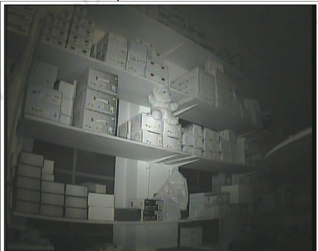
hier wurde der Shutter manuell nachgeregelt: Einstellung 1/240 Sekunde. Umgekehrt gibt es die Möglichkeit bei zu großer Dunkelheit einen langsamen Shuttermodus zu wählen.
