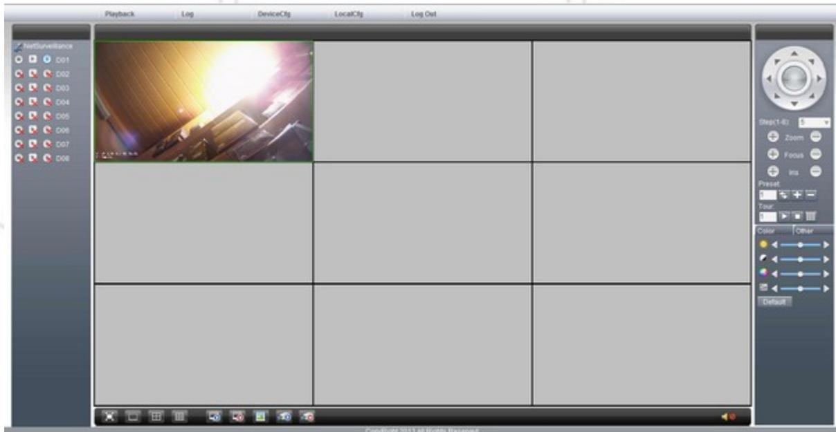
Die Weboberfläche des Recorders können Sie mit dem Internetexplorer erreichen. Die Funktionen sind fast identisch mit dem Funktionsmenü des Recorders. Der Recorder steht standardmäßig auf DHCP. Das heißt, er bekommt vom Router automatisch eine IP-Adresse zugeteilt. Um diese IP-Adresse herauszufinden, rufen Sie zuerst das Kontextmenü des Recorders auf, dann MAIN MENU > SYSTEM > NETWORK.
