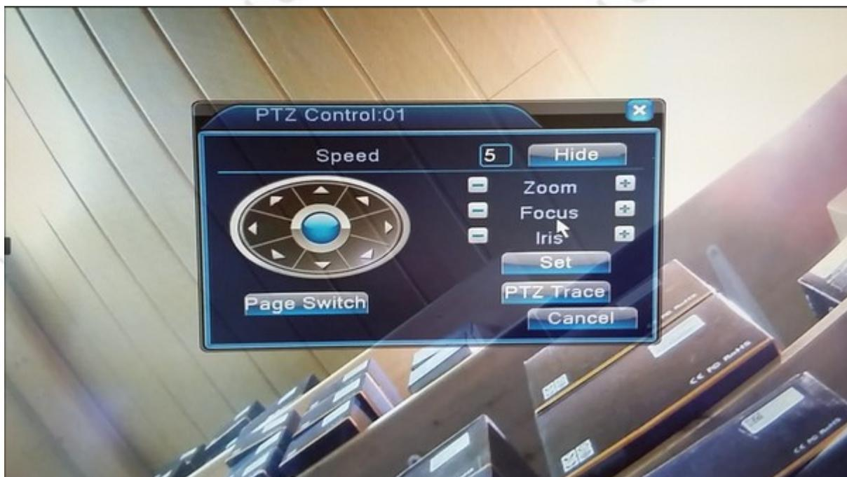
**PTZ Control:** mit diesen Steuerelementen kann eine PTZ Kamera, zB. eine Speeddome gesteuert werden.
