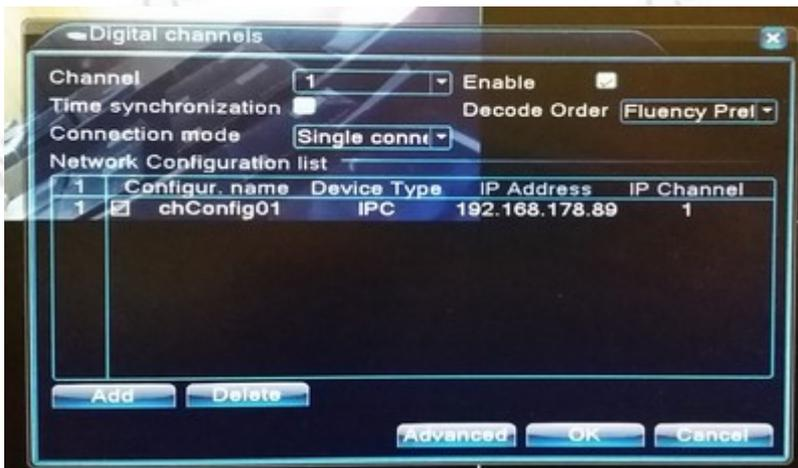
es öffnet sich ein Konfigurationsfenster. Hier können Sie oben unter Channel nochmals den einzustellenden Kanal / Kamera ändern, ein Haken auf Enable aktiviert die Kamera – bzw. die Kameras sind standardmäßig schon aktiviert, das entfernen des Häkchens deaktiviert die Kamera. Unter Decode Order können Sie verschiedene Bilddarstellungen auswählen. Diese verändern die Einstellung nur geringfügig.
