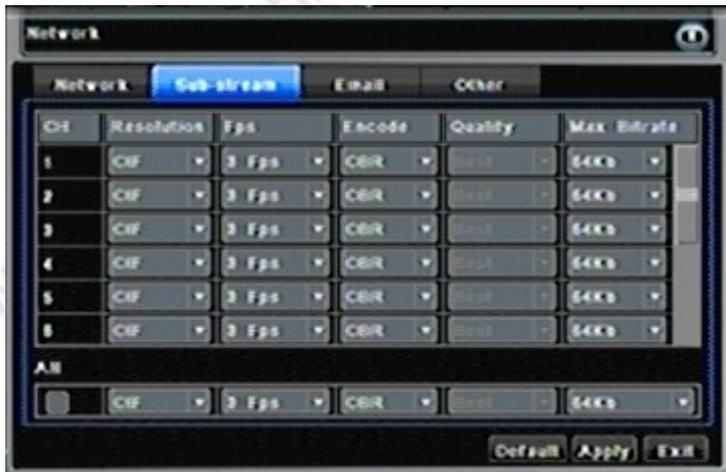
Da es über das Mobilfunknetz und in Anbetracht eines relativ kleinen Handy-Displays normalerweise keinen Sinn macht die Daten aller Kameras mit der höchsten Auflösung zu senden, besteht hier die Möglichkeit einen 2. Datenstrom mit einer separaten Auflösung, Framerate und Bitrate festzulegen, der nur für die Abfrage mit einem Smartphone oder Tablet-PC gedacht ist. Dieser Datenstrom wird automatisch über den im Feld "Mobile Port" vergebene Portadresse weitergeleitet.
