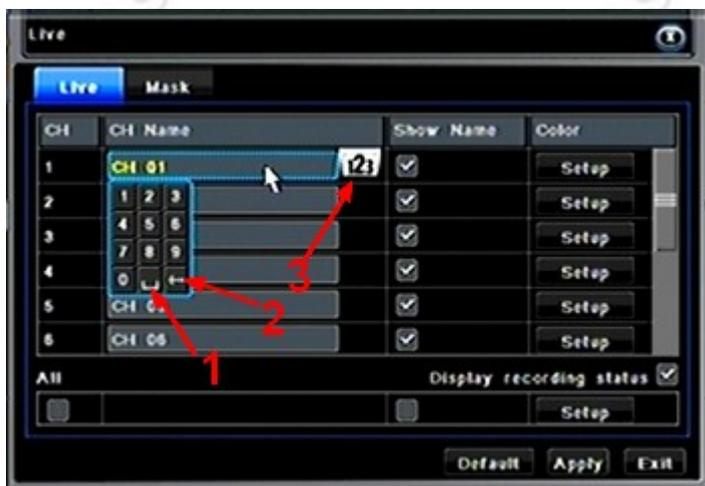
3.3.2) klicken Sie dann auf den Reiter "Live" und anschließend in die Bezeichnung der Kamera. Es öffnet sich eine kleine Bildschirmtastatur, welche mit der Maus bedient werden kann. Mit dem gekennzeichneten Symbol 1 können Sie ein Leerzeichen einfügen, mit Symbol 2 können Sie das vorherige Zeichen löschen, mit dem Symbol 3 können Sie zwischen Nummerntastatur, Buchstaben und Sonderzeichen umschalten.
