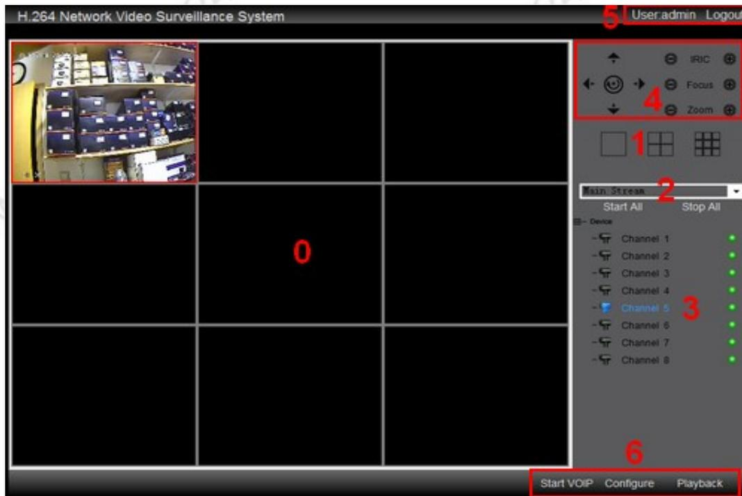
die Weboberfläche des Recorders erscheint zunächst ohne jegliches Kamerabild. Sie können die an den Recorder angeschlossenen Kameras aber frei den vorhandenen Feldern zuordnen.
