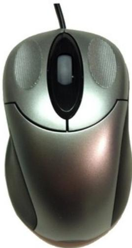
**linke Maustaste:** Menüs und einzelne Funktionen anwählen, in geteilter Mehrfachbildansicht vergrößert Doppelklick auf eine Kamera dieses Bild zum Vollbild.
