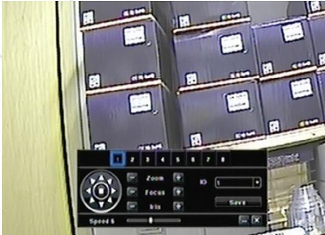
3.6.4.2) Fenster für die Steuerung einer PTZ-Kamera.
