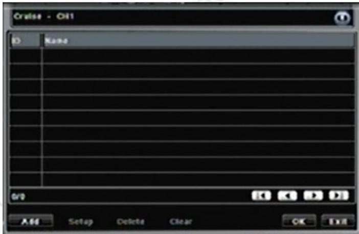
3.6.5.1) um einen Kameraschwenk zu programmieren, drücken Sie zuerst unten links auf die Taste "Add" (= addieren / hinzufügen). Sie können im Prinzip beliebig viele Kameraschwenks hinzufügen. Diese müssen dann nacheinander abgearbeitet, bzw. programmiert werden.
