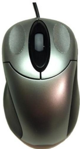
**linke Maustaste:** Menüs und einzelne Funktionen anwählen, in geteilter Mehrfachbildansicht vergrößert Doppelklick auf eine Kamera dieses Bild zum Vollbild.
