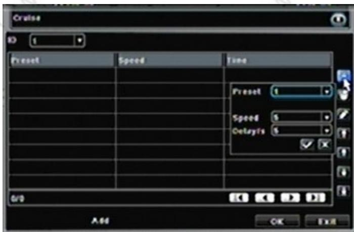
3.6.5.4) es öffnet sich ein kleines Fenster, in welchem Sie eine Presetposition auswählen können, zusätzlich können Sie die Geschwindigkeit (Speed) einstellen, mit welcher dieser Punkt angefahren wird (sofern Ihre Kamera diese Funktion unterstützt), außerdem die Verweildauer auf diesem Punkt (Delay / S) in Sekunden, bevor die Kamera weiter zum nächsten Punkt fährt.
