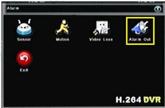
4.7.1) klicken Sie im Menü "Alarm" auf das Symbol "Alarm Out" (= Alarm-Ausgang)
