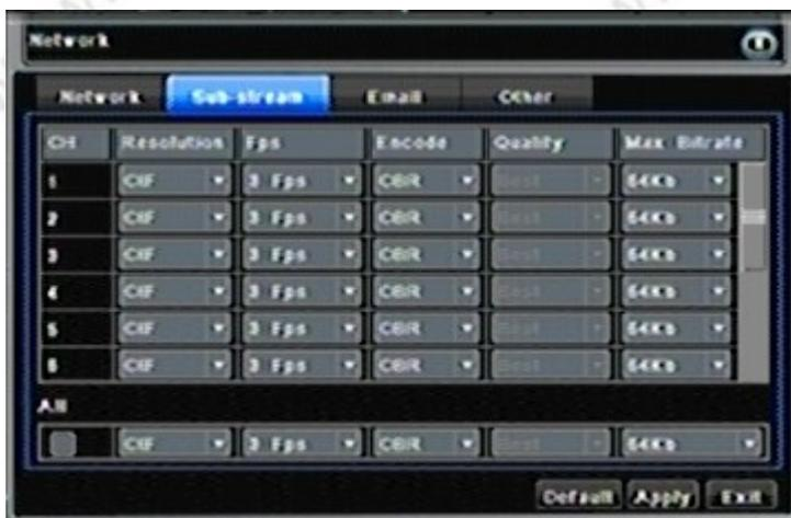
Da es über das Mobilfunknetz und in Anbetracht eines relativ kleinen Handy-Displays normalerweise keinen Sinn macht die Daten aller Kameras mit der höchsten Auflösung zu senden, besteht hier die Möglichkeit einen 2. Datenstrom mit einer separaten Auflösung, Framerate und Bitrate festzulegen, der nur für die Abfrage mit einem Smartphone oder Tablet-PC gedacht ist. Dieser Datenstrom wird automatisch über den im Feld "Mobile Port" vergebene Portadresse weitergeleitet.
