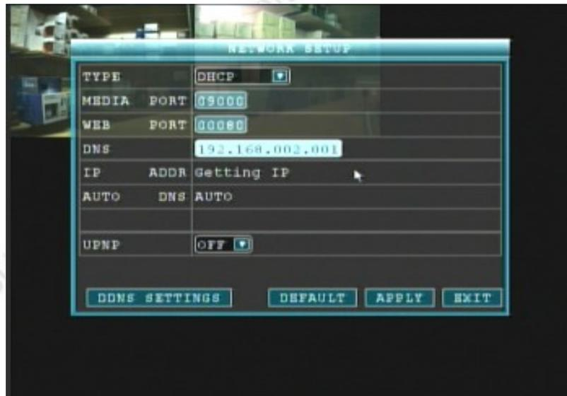
Falls Sie möchten, daß Ihr Router die IP-Adresse automatisch an Ihren Recorder vergibt, dann aktivieren Sie zunächst im Feld TYPE die Einstellung DHCP und klicken Anschließend auf APPLY. Nach einer kurzen Info fährt der Recorder neu hoch und Sie finden in dieser Maske bereits die passenden Einstellungen für die Abfrage über Ihr Netzwerk vor.
