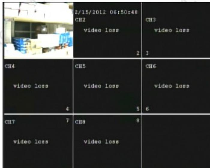
je nach Recordermodell wird jetzt ein 4-geteilter oder 8-geteilter Bildschirm angezeigt. Alle Recorderkanäle an welche keine Kamera angeschlossen ist werden als "video loss" (= Videoverlust) beschriftet.
