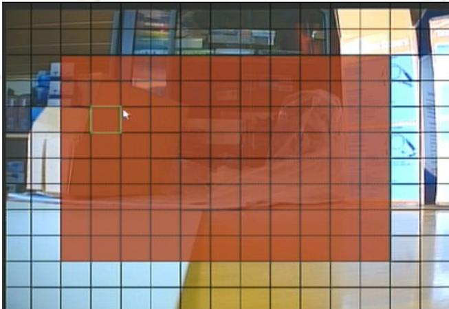
Die roten Felder symbolisieren den Bereich, der auf Bewegung überwacht wird. Über einen Klick mit der Maus können diese Felder aktiviert oder deaktiviert werden. Um Fehlalarme bzw. Fehlaufzeichnungen möglichst auszuschließen, empfehlen wir diesen Bereich möglichst einzuschränken. Wenn z.B. nur eine Tür überwacht werden soll, dann sollten die roten Felder auch nur den Bereich der Tür abdecken.
