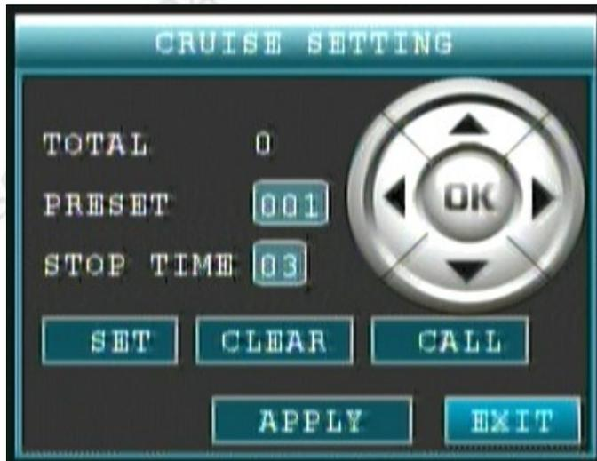
Um eine Kameraroute zu programmieren fahren Sie zunächst mit dem Steuerkreuz an eine beliebige Position, welche bei der Kameraroute mit angefahren werden soll. Klicken Sie jetzt auf SET um diesen Punkt in die Kamerafahrt aufzunehmen. Tragen Sie unter STOP TIME eine Verweildauer auf diesem Punkt in Sekunden ein (z.B. 03).
