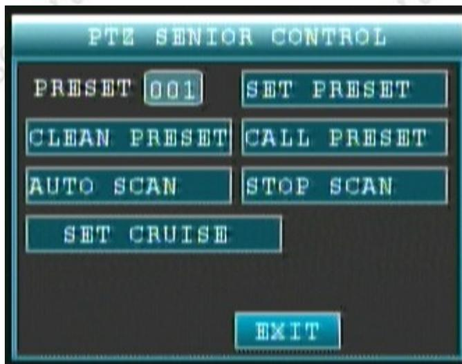
Über dieses Menü werden per Kamera anfahrbare Fixpunkte (PRESETPOSITIONEN) festgelegt. Außerdem kann ein Ablauf aus diesen Fixpunkten als selbstständige Kamerafahrt (CRUISE) programmiert werden:
