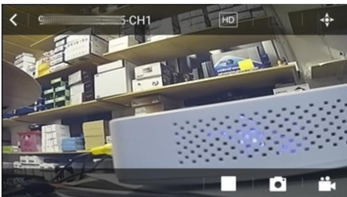
Vollbild einer Kamera mit Bedienelementen. Wie schon in der Übersicht, lassen sich über die Bedienelemente unten Aufzeichnungen fertigen. Über das Kreuz-Symbol oben rechts öffnet sich ein Popup Menü zur Steuerung von PTZ-Kameras. Über das HD-Symbol oben läßt sich der Datenstrom umschalten. Falls es sich um eine HD IP-Kamera handelt, kann hier vom 1. Datenstrom (stream 1) zum 2. Datenstrom (stream 2) gewechselt werden.
