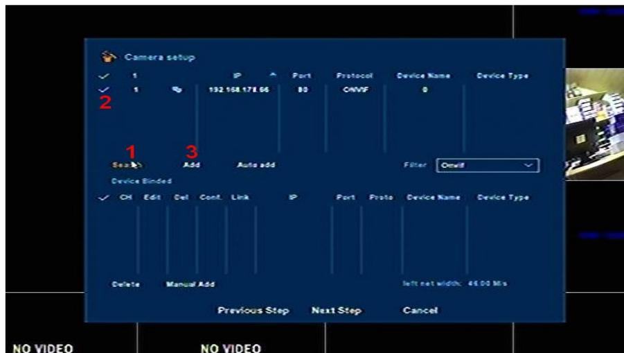
1 - klicken Sie auf Search – falls die Kamera oben noch nicht automatisch angezeigt wird. sofern die angeschlossenen IP-Kameras im Netzwerk zuvor richtig konfiguriert wurden, und es sich um ONVIF IP-Kameras handelt, werden diese jetzt im oberen Feld angezeigt und können eingebunden werden.
