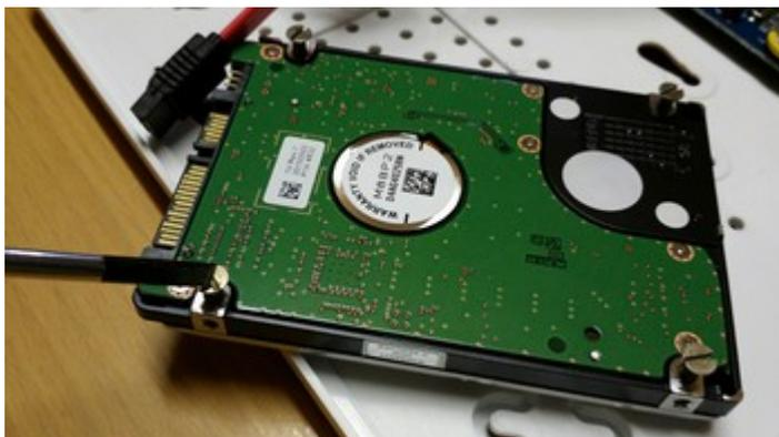
Nehmen Sie eine SATA Festplatte 2,5" oder 3,5" und schrauben in die 4 vorgesehenen Gewinde passende Festplattenschrauben ca zur Hälfte ein.
