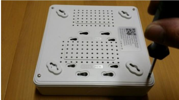
Entfernen Sie die unteren 4 Gehäuseschrauben des Recorders
