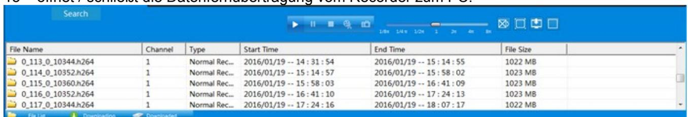
Die Dateien können per Rechtsklick und auswählen von "Remote Download" auf die Festplatte des PC heruntergeladen werden. Bei bewegungsgesteuerten Aufzeichnungen funktioniert das relativ zügig, bei Daueraufzeichnung beträgt die Datengröße 1022 MB und nimmt über das Netzwerk einige Zeit in Anspruch.
