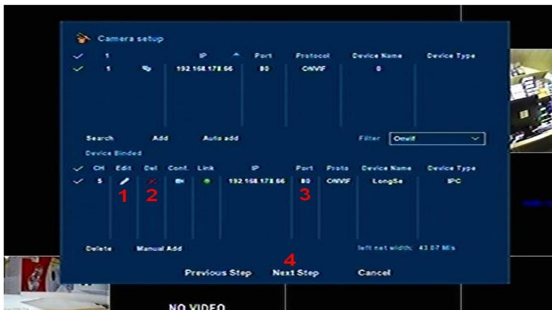
Im Idealfall könnte die Kamera ohne weitere Konfiguration auch gleich laufen und das Bild in der Bildschirmmaske erscheinen. In der Spalte Link erscheint die Kamera zuerst noch als roter Punkt, dieser Punkt färbt sich anschließend grün, und die Kamera läuft.
