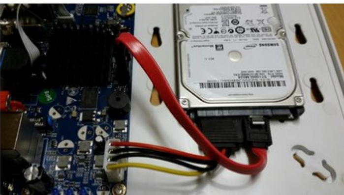
Verbinden Sie jetzt die SATA Anschlüsse des Recorders mit der Festplatte und schließen anschließend den Recorder wieder mit dem Gehäusedeckel.
