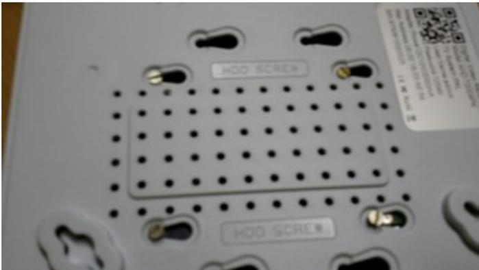
Drehen Sie den Recorder um, und verschieben die Festplatte etwas, sodaß die Schrauben in den vorgesehenen Veranzungen einliegen. Drehen Sie die Festplatte anschließend fest. Achtung: die Schrauben sind nicht Bestandteil des Recorders ! Achten Sie auf die Länge der Schrauben bei 2,5" Festplatten !
