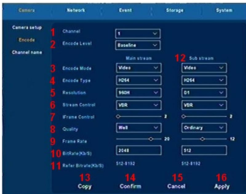
1 – Auswahl Kamerakanal: hier können Sie für die analogen Kameras Kanal 1 – 4 einstellen, je nachdem an welchem Kanal die Kamera angeschlossen ist. Die Kanalnummer ist auf der Gehäuserückseite an den Anschlüssen gekennzeichnet. Die Belegung der Anschlüsse wird in einem gesonderten Menü festgelegt. Beschreibung gleich im Anschluß !
