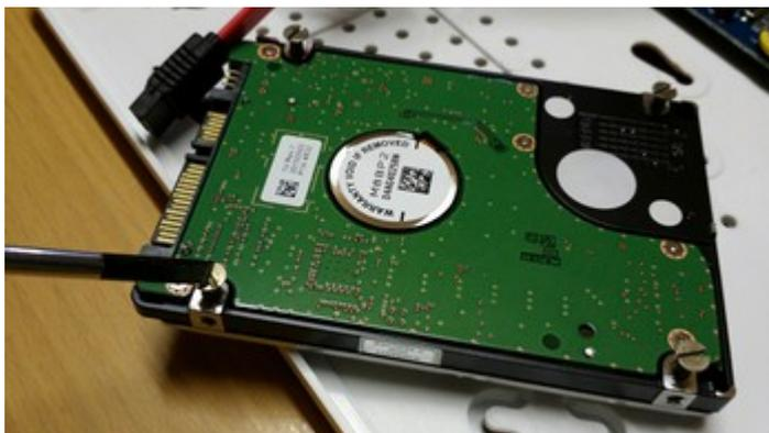
Nehmen Sie eine SATA Festplatte 2,5" oder 3,5" und schrauben in die 4 vorgesehenen Gewinde passende Festplattenschrauben ca zur Hälfte ein.
