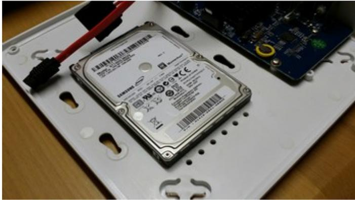
Drehen Sie die Festplatte um, sodaß die 4 halbeingedrehten Schrauben durch die vorgesehenen Aussparungen im Boden des Recorders passen. Für 2,5" Festplatten sind das die Inneren, für 3,5" Festplatten die äußeren Aussparungen.
