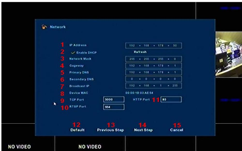
Diese Einstellungen werden für den Betrieb von Onvif-IP-Kameras benötigt und für die Fernabfrage des Recorders.
