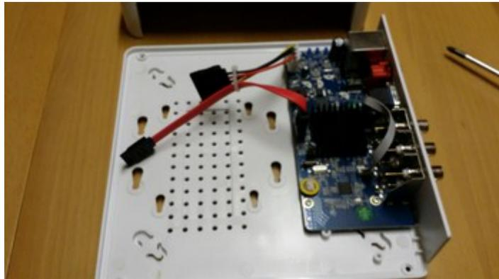
Drehen Sie den Recorder wieder um und heben das Gehäuse vom Boden ab.
