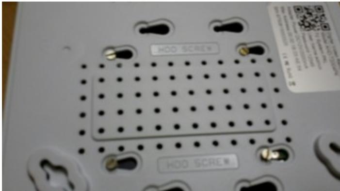
Drehen Sie den Recorder um, und verschieben die Festplatte etwas, sodaß die Schrauben in den vorgesehenen Veranzungen einliegen. Drehen Sie die Festplatte anschließend fest. Achtung: die Schrauben sind nicht Bestandteil des Recorders ! Achten Sie auf die Länge der Schrauben bei 2,5" Festplatten !
