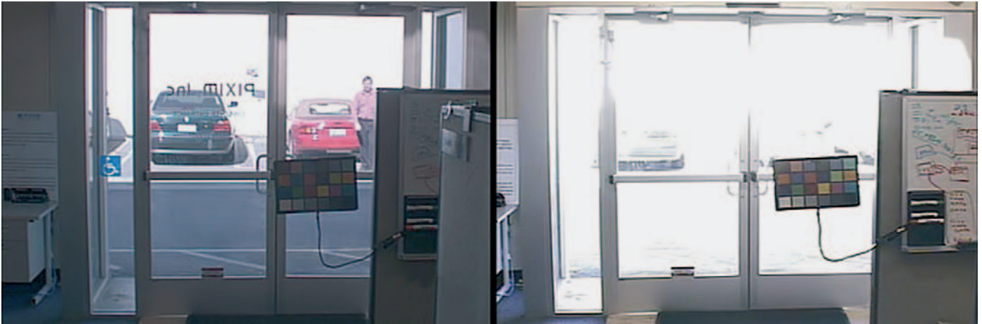
Bild 6: Während beide Sensoren in diesem Anwendungsbeispiel die Farbtafel im Vordergrund gut wiedergeben, überstrahlt der Hintergrund bei herkömmlichen Sensoren und löscht damit wichtige Details
