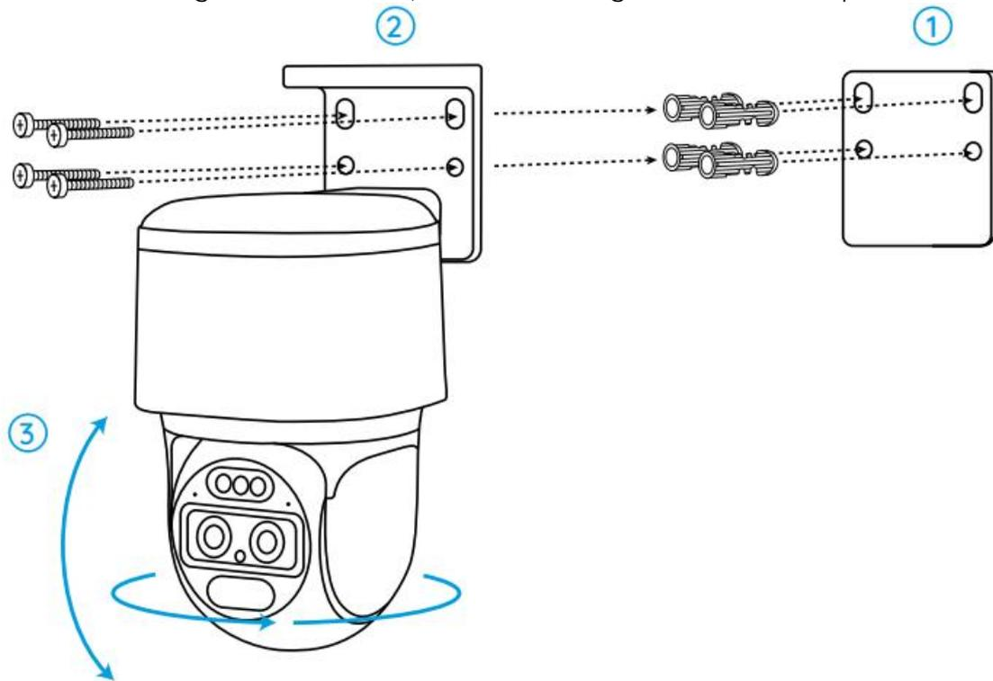
**Hinweis:** Bei der Befestigung an harten Oberflächen, wie z. B. einer Trockenbauwand, die im Paket enthaltenen Dübel für Trockenbauwände verwenden.
