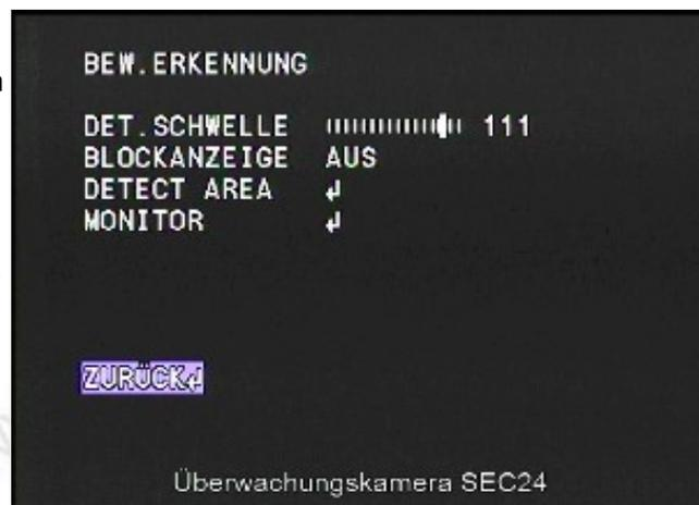
**DETECT AREA:** hier können Bereiche im Kamerabild weiß maskiert werden. Diese werden anschließend auf Bewegung untersucht. Standardmäßig ist das komplette Kamerabild maskiert.
