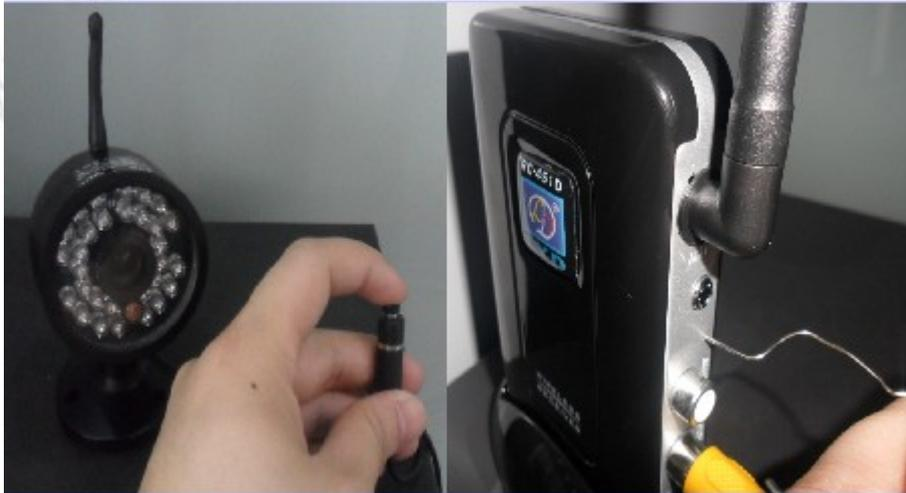
drücken Sie gleichzeitig an Kamera und Receiver den Codierschalter für ca. 5 Sekunden und lassen dann wieder los. (für den Schalter hinter der kleinen Öffnung am Receiver nehmen Sie z.B. eine aufgebogene Büroklammer oder Kugelschreiber zur Hilfe)
