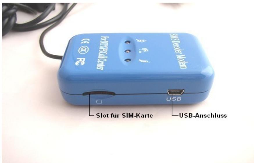
**Seitenansicht rechts** mit USB-Anschlußbuchse für den Anschlußadapter
