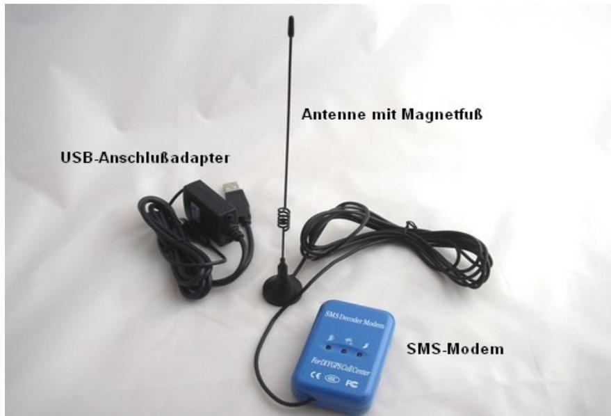
**Übersicht:** SMS-Modem mit Magnetfußantenne. Da alle SMS-Modems ursprünglich für den Anschluß an eine serielle Schnittstelle konzipiert waren, diese Schnittstelle heutzutage aber nicht mehr zeitgemäß ist, befindet sich außerdem ein Anschlußadapter für USB im Lieferumfang.
