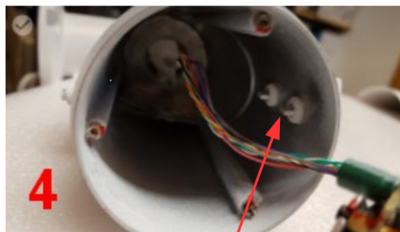
Bild 4) so sehen die Stellschrauben vom Innern der Kamera aus. Wenn die beiden länglichen Bolzen nicht gerade nach außen stehen, ist es etwas schwieriger, das Modul aus der Kamera zu ziehen. Bild 6) es funktioniert aber auch bei querstehenden Bolzen.
