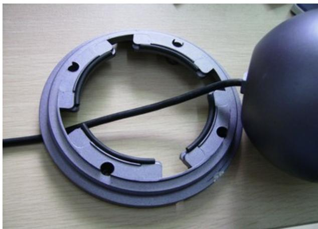
Markieren Sie durch die 4 Löcher im jetzt abgeschraubten Boden der Kamera die Stelle an der Decke für die Befestigung. Nach dem Bohren der Löcher, und einsetzen der Dübel können Sie die Kamera wieder zusammenschrauben.
